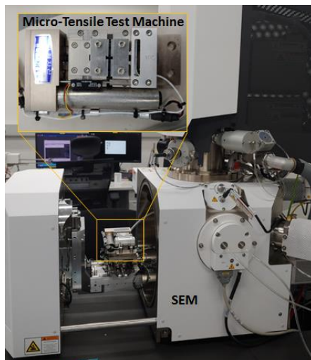
Fig.1 Microscale tensile test machine in SEM
